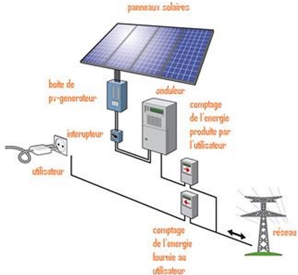
schema de l'installation du photovoltaïque :
